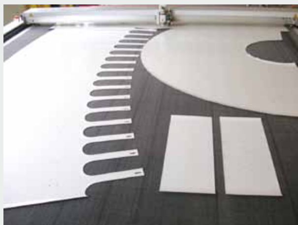
Mittels eines eigens angepassten Post-Prozessors kann das Zeichenprogramm Fertigungsdaten direkt über die serielle Schnittstelle an den Schneidplotter senden. Die Reihenfolge der Zeichnungsobjekte bestimmt dabei die Schnittabfolge
